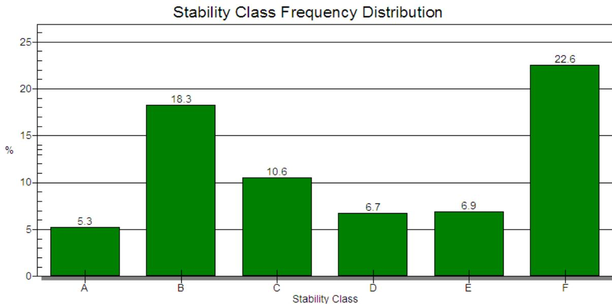
**FIGURE 9: SHOWING CLASS STABILITY FREQUENCY DISTRIBUTION**
